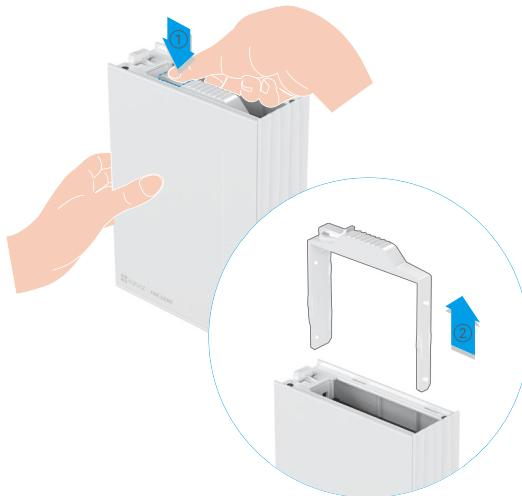
3. 按照指示圖的方向將已取下的支架定位，然後使用四個螺絲將磁盤（單獨購買）固定在其上。
