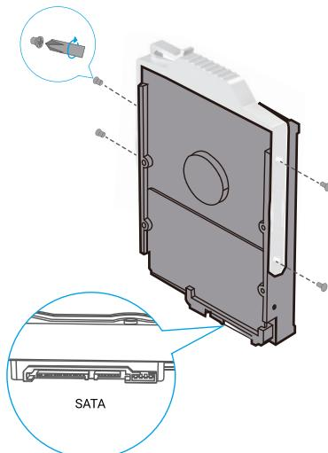
● 安裝磁盤時，請將支架安裝在距離 SATA 端口較遠的裝置末端。
